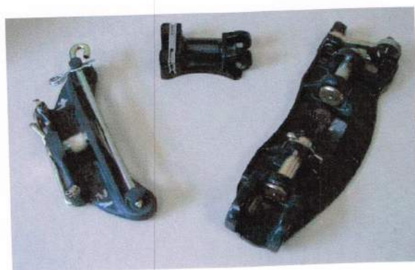
Bremsbackenhalter für Personen- u. Niederflurwagen
